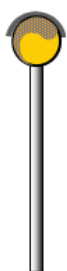
Figura 2: lampeggiatore a led alta efficienza diam. 300 mm alimentato con batteria da autovettura, da utilizzare su entrambi i lati della carreggiata anche in più sequenze (cantieri di lunga durata)
